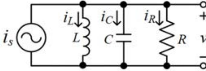
34 如圖所示之  $RLC$  串聯電路，已知  $L = 50 \mu\text{H}$ ， $C = 0.47 \mu\text{F}$  及  $R = 5 \Omega$ ；求此電路的品質因數 ( $Q$ ) 約為何？
