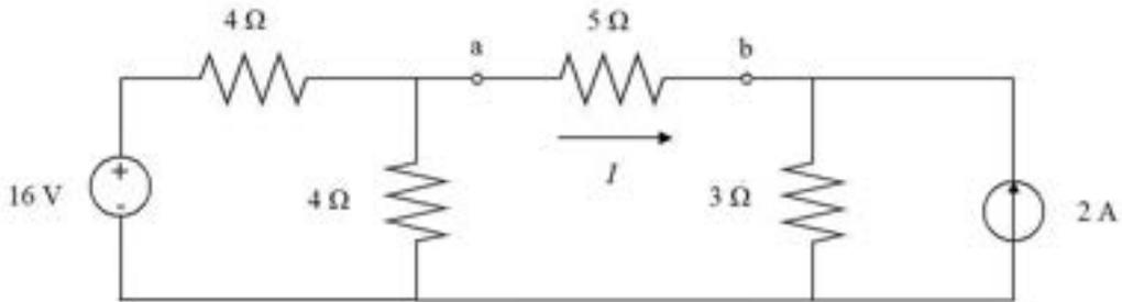
13 如圖所示之電路，求電流  $I$  之值約為何？
