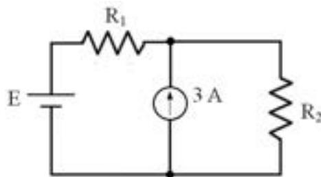
19 如圖所示之電路，求電阻  $R$  之最大功率值為何？
