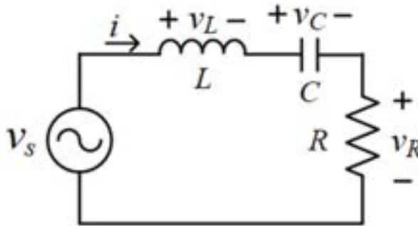
35 一個  $70.7 \sin(377t)$  伏特之交流電源，施加於阻抗值為  $3-j4$  歐姆之  $RLC$  串聯電路中，求電源供給予該電路之視在功率約為多少伏安？
