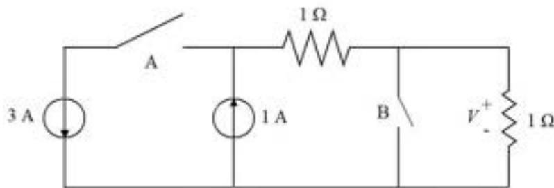
17 如圖所示之電路，若 A 點的電壓  $V_A$  為 9 伏特 (V)，若利用節點分析法，可求出 B 點的電壓為多少伏特？
